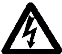
Gevaar voor elektrische spanning
